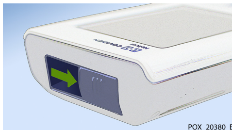
Figur 3-1. Dæksel til sensorport
